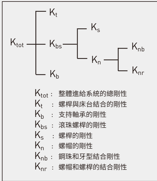
圖 4.28 滾珠螺桿進給系統的架構
